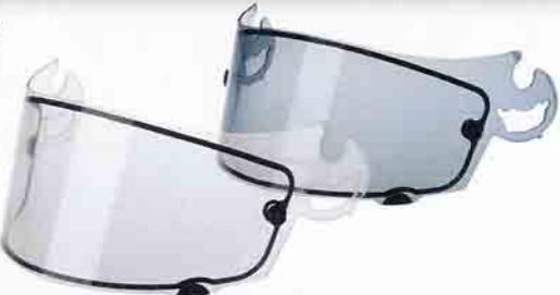
MOTO-GPライダーが、雨のレースで秘密兵器として使用しているのがSALダブルレンズシールドです。スーパーアドシスLシールドの全長を伸ばし空間を設け、内側に曇り止めレンズを重ね、空気の断熱層によりレンズ内外の温度差を少なくすることで曇りを防ぐ構造です。昨シーズン後半より、F-1レース用で試作品を実戦投入して効果を確認した上で、今シーズン初めよりMOTO-GPでも使用を開始しました。従来の曇り止めシールドよりも格段に優れた効果を有し、F-1、MOTO-GPいずれのトップレースにおいても、雨による過酷な条件の中で、曇りに関して安心できると高い評価を得ています。
