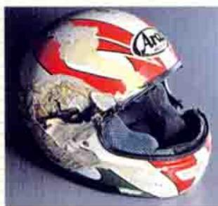
上記のような側面を持つ新JIS規格をベースに進められていたハイパーTの開発ですが、ヨーロッパから送られてきた1個のヘルメットがきっかけとなり、大きな変更を余儀なくされました。写真にある、帽体部が引き剥がされたようなヘルメットがそれです。送り主であるライダーの話によると、4輪車に激突しそうになって転倒したところ、車と地面の間に挟まれ、引きずられてしまったそう。ところが、奇跡的に頭には外傷がなく、助かったとのこと。ヘルメットは、その状態と共に送られてきました。尚、このライダーが乗っていたのはスクーターだそうです。
