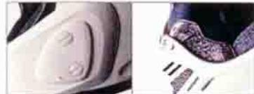
マウスガードタイプの特徴は、個々の顔に合わせ、マウスガードの位置を自在に変えられること。同時に、オフロードヘルメットの特徴である尖ったマウスガード部が、軟弱な路面に激突した際に、マウスガード自体の変形、あるいはプラスチックネジの破損により、首への衝撃をやわらげることです。MX-IIIでは、マウスガード本体の剛性を上げると共に、前後上下の調整位置を広げることにより、口元のクリアランスを確保し、激しい動きでの呼吸を楽にしています。
